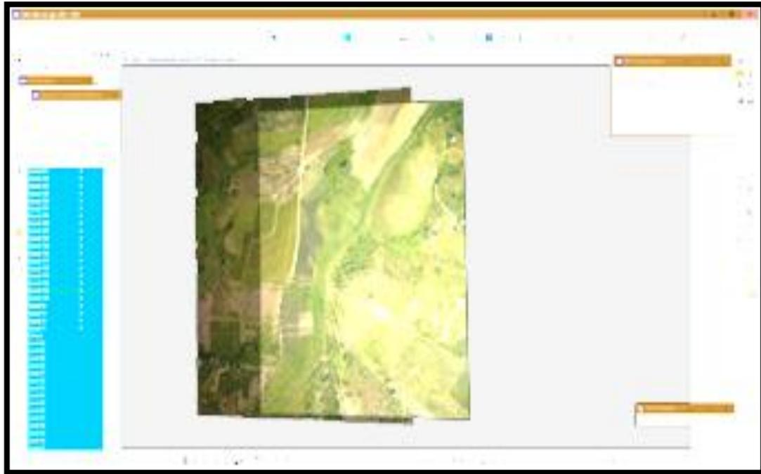
Modelos estereoscópicos listos para restituir
