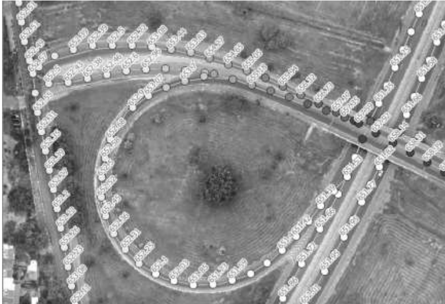
Fig. 5: Muestra los buffer de 0.6 metros con la cota promedio asignada luego del procesamiento. Los colores oscuros indican más altura.
