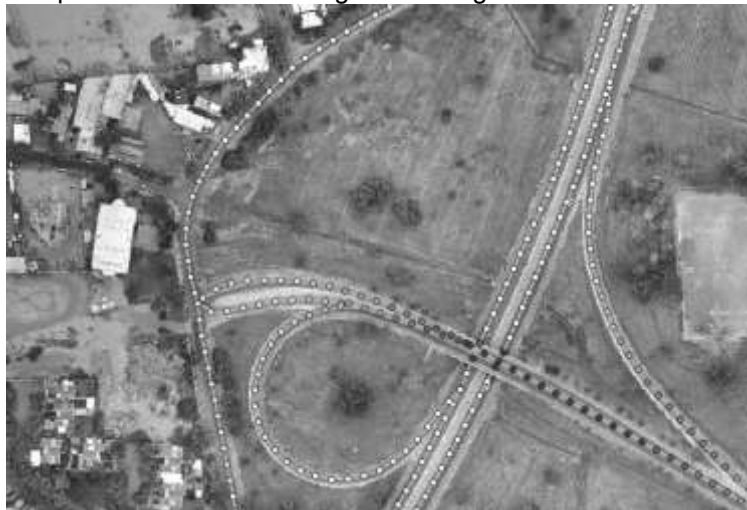
Fig. 4: ejes de ruta con segmentación cada 10 metros. La graduación de colores indica los valores z luego del proceso
