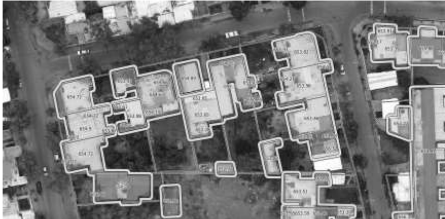
Figura 2: contorno de mejoras para calcular cota de piso
